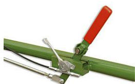
Manetă acționare înainte-înapoi cu reducerea automată a accelerației.
